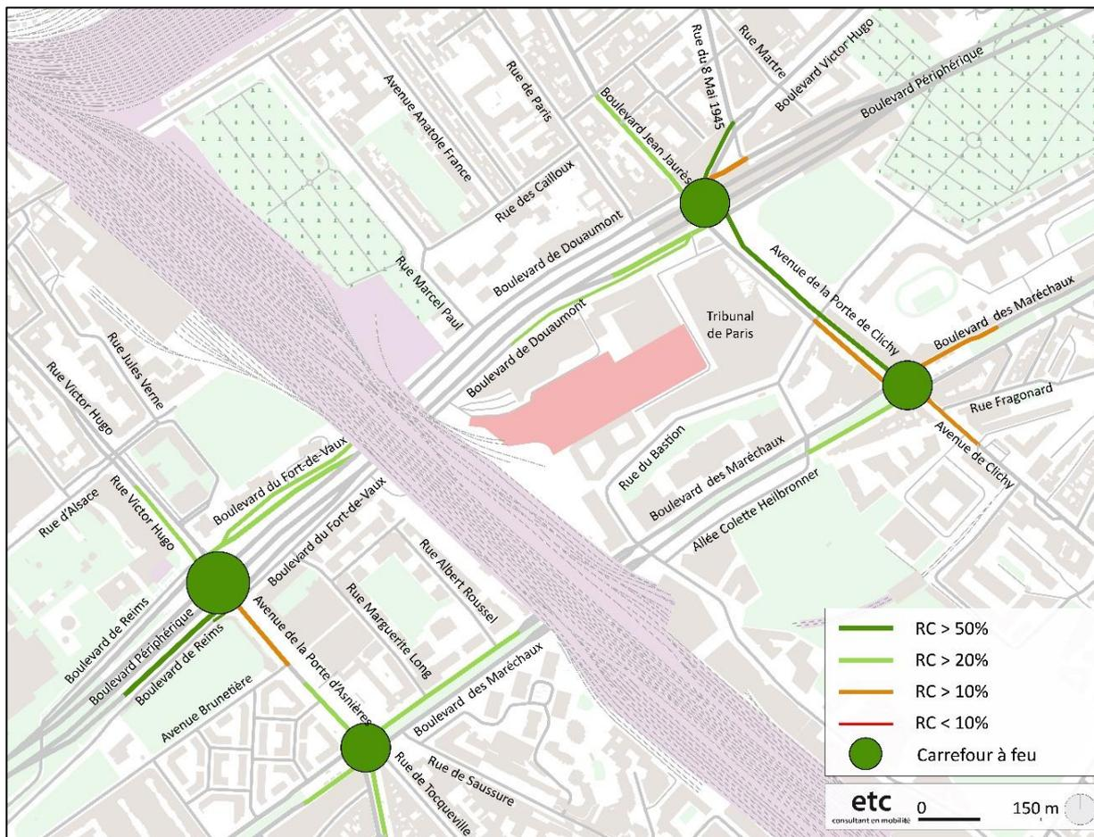
Réserves de capacité des carrefours avec le projet à l'HPM - ETC
