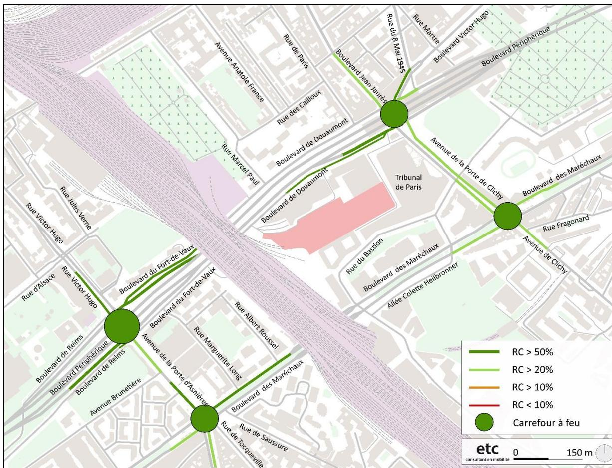
Réserves de capacité des carrefours avec le projet à l'HPS - ETC
