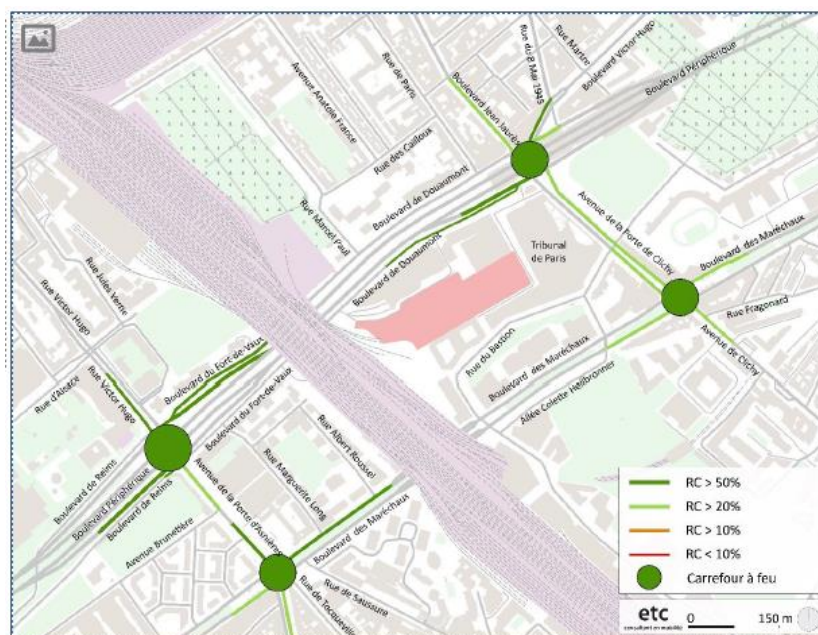
Figure 100 : Réserves de capacité des carrefours en l'état actuel à l'HPS (source : ETC)
